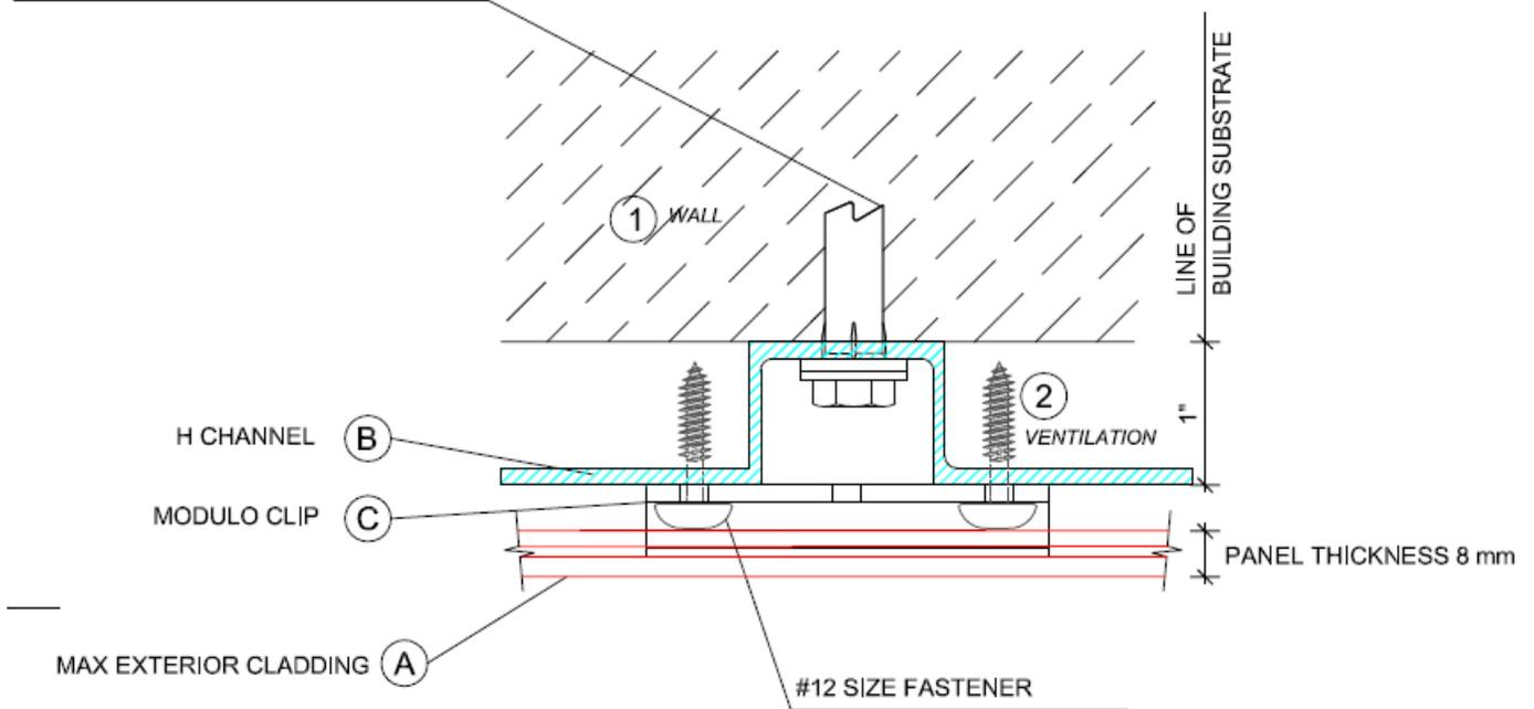
FIGURE 3 – TYPICAL DETAIL – MODULO SYSTEM – HORIZONTAL PANEL JOINT
