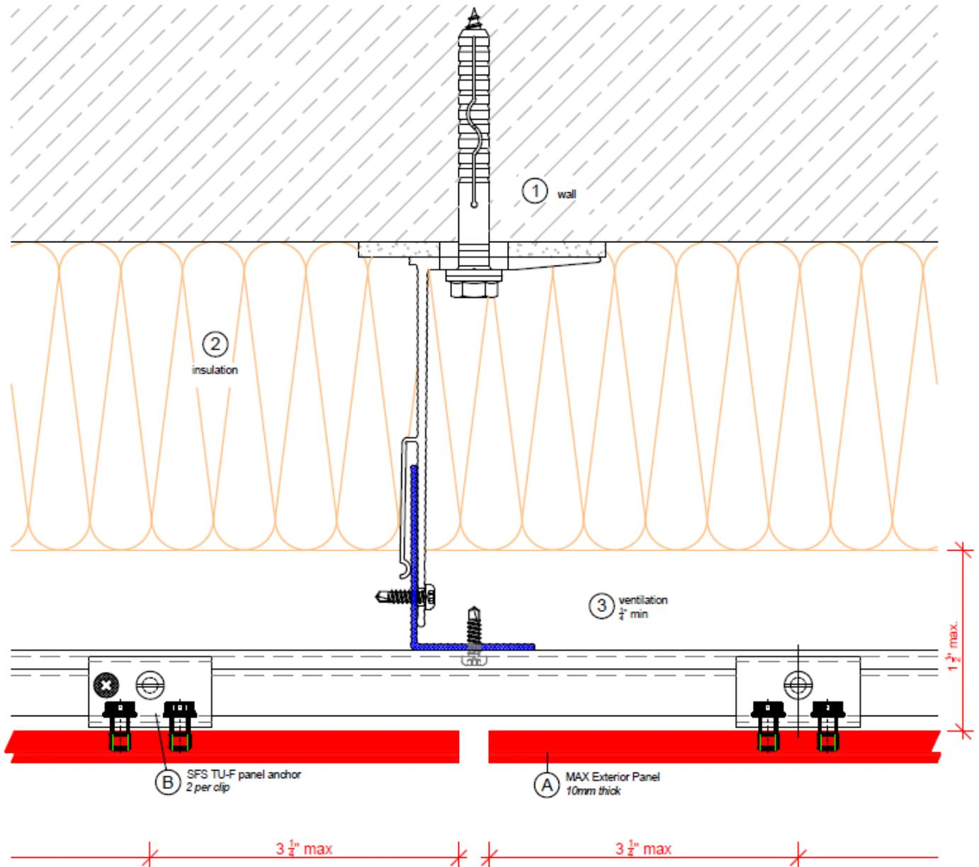
FIGURE 2 – TYPICAL DETAIL – CONCEALED FASTENER SYSTEM
