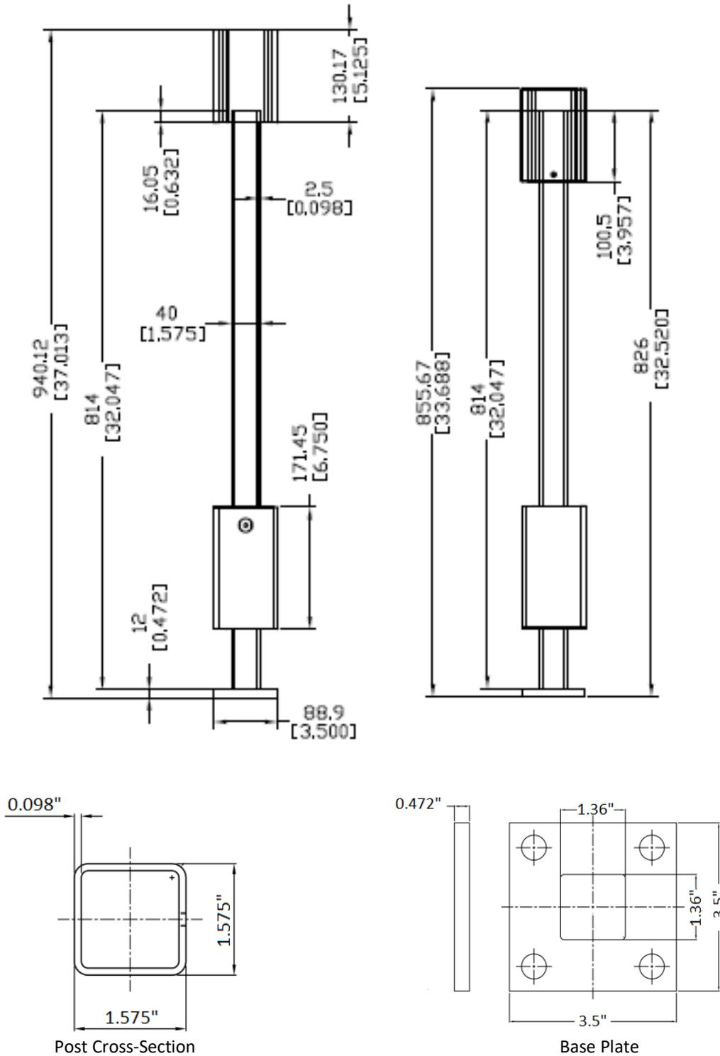
FIGURE 3 – ADVANTAGE PLUMB PERFECT POST MOUNT SYSTEM
